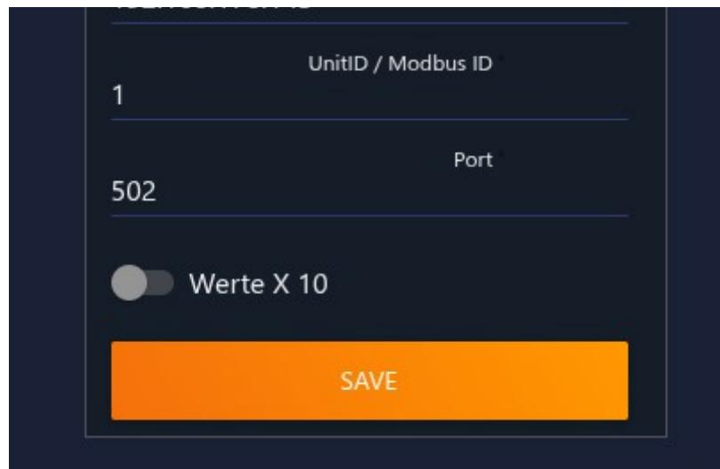
Der Schalter mal 10 rechnet die PV W, Grid W, Charge W und Discharge mit dem Faktor 10 so werden aus z.B. 150 = 1500.
