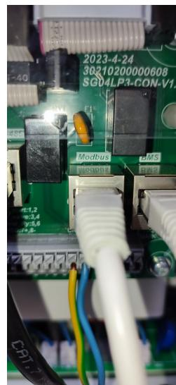
5. Verbinde den RS485 Ausgang mit dem Modbus/ RS485 Port am Wechselrichter.
